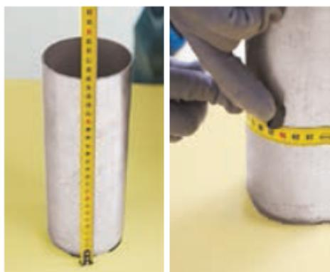
Одна сторона прямоугольника равна длине окружности трубы +50 мм, а вторая равна длине гильзы +100 мм. Выполните необходимые замеры и раскрой материала для заготовки.
