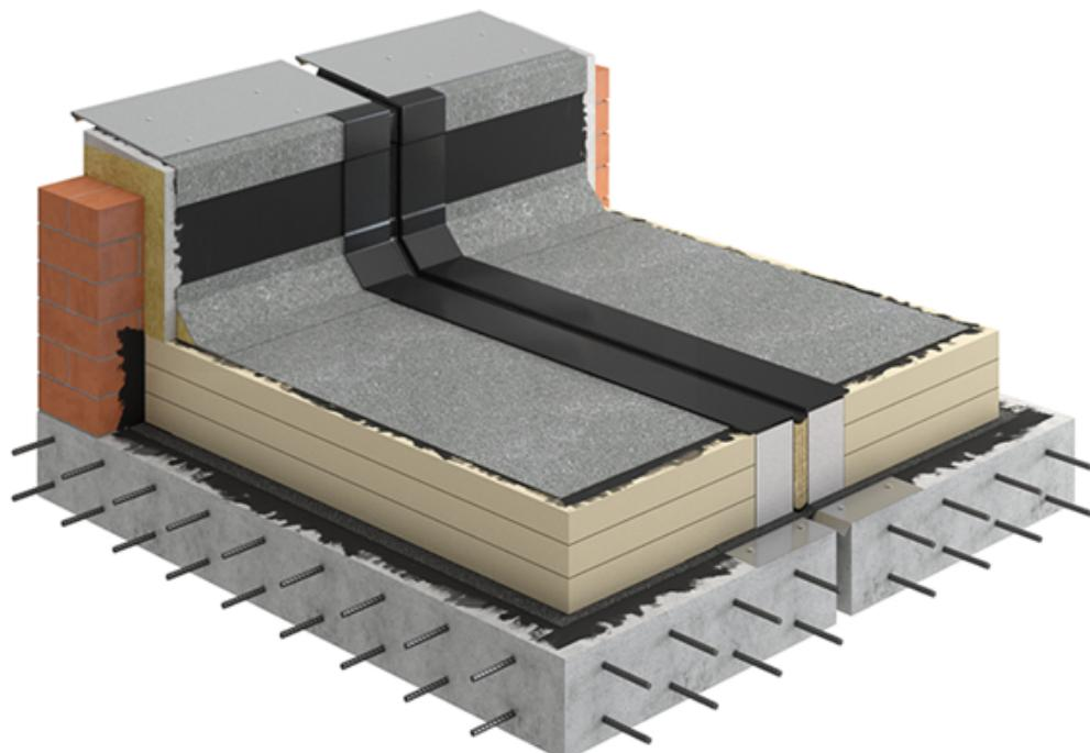
Далее в деформационный шов укладывается Гернитовый шнур ТН Фундамент или скатанный в рулон кровельный материал (диаметром рулона 50 мм), поверх которого укладывается второй слой ТЕХНОНИКОЛЬ ФЛЕКС.
