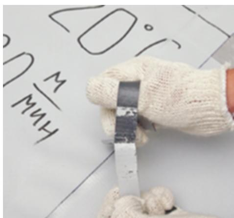
Мембрана «отлипает» (шов разделяется без усилия), нет когезионного разрыва. Для получения качественного сварного шва уменьшайте скорость сварки, либо увеличивайте температуру сварки.
