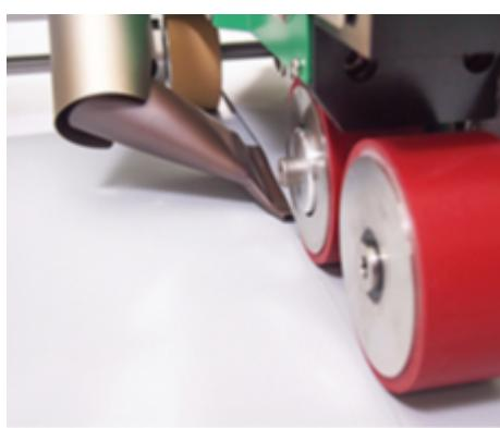
Следите за тем, чтобы кончик сопла выступал из наружной границы шва на **2-3 мм.**
