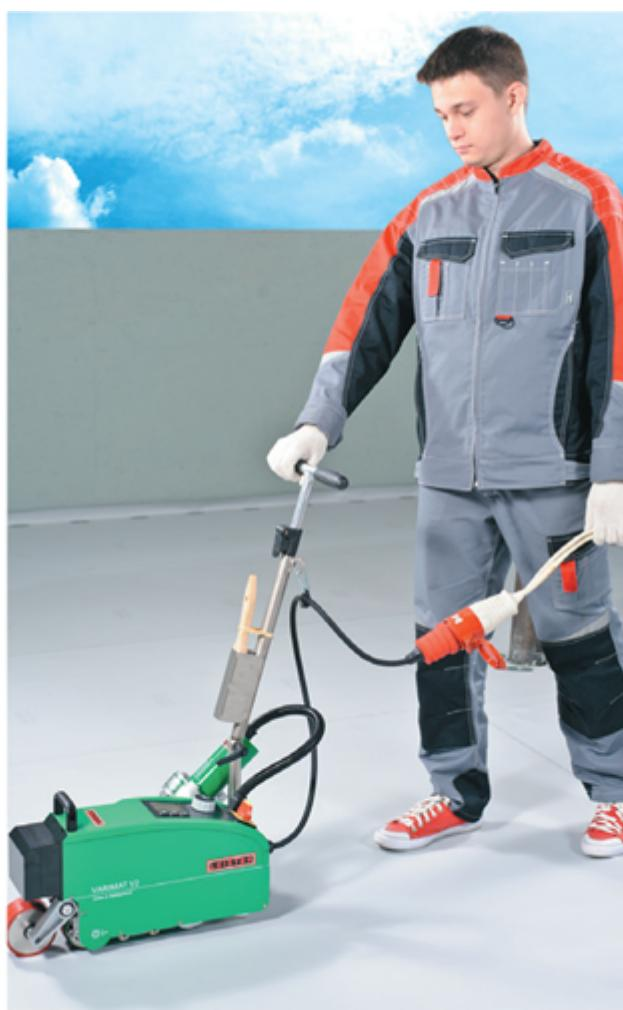
Продолжайте монтаж мембранны с использованием автоматического сварочного оборудования. Очистку сопла необходимо выполнять после каждого изъятия его из шва, когда аппарат имеет рабочую температуру.
