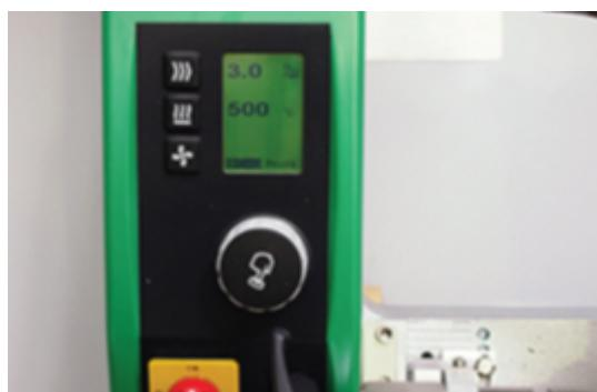
Перед началом сварочных работ выставьте параметры (температуру воздуха, скорость движения сварочного аппарата).
