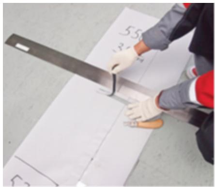
После полного остывания сварного шва (при высокой температуре окружающей среды для этого может потребоваться до **20 минут**) вырежьте из середины каждого участка пробную полоску сваренной мембрани шириной **20-30 мм** и разорвите шов.
