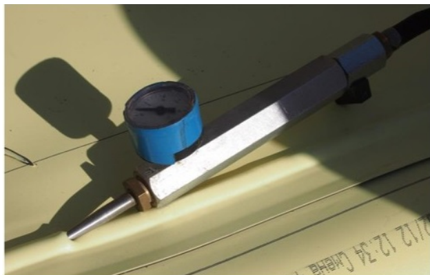
Проверка герметичности двойного шва избыточным давлением воздуха.
