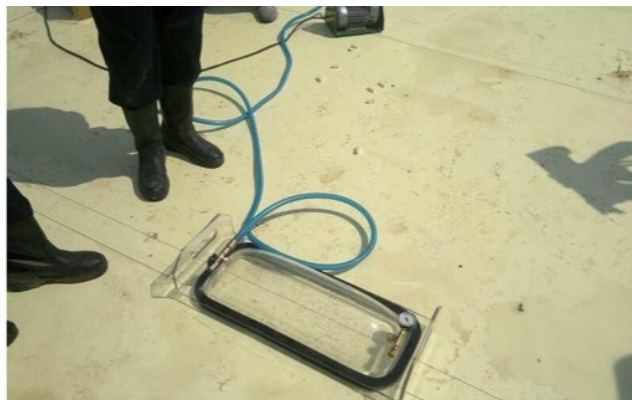
Проверка герметичности швов с помощью вакуумного колпака.
