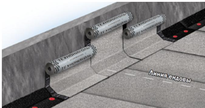
Расстояние между боковыми стыками кровельных полотнищ в смежных слоях на парапете должно быть 300—600 мм.
