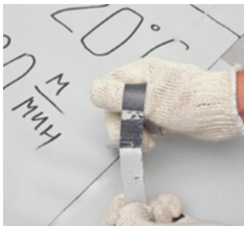
Мембрана «отлипает» (шов разделяется без усилия), нет когезионного разрыва. Для получения качественного сварного шва уменьшайте скорость сварки, либо увеличивайте температуру сварки.
