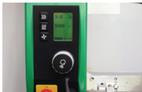
Перед началом сварочных работ выставьте параметры (температуру воздуха, скорость движения сварочного аппарата).
