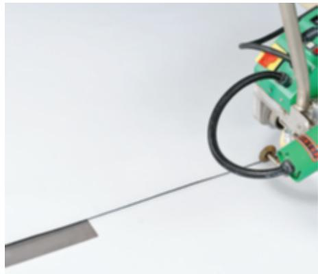
В конце шва установите вторую металлическую пластину. При наезде прикаточного колеса автомата на пластину вытаскивайте сопло из нахлеста – автомат при этом остановится. Счищайте нагар с сопла аппарата с помощью щетки из мягкого металла.
