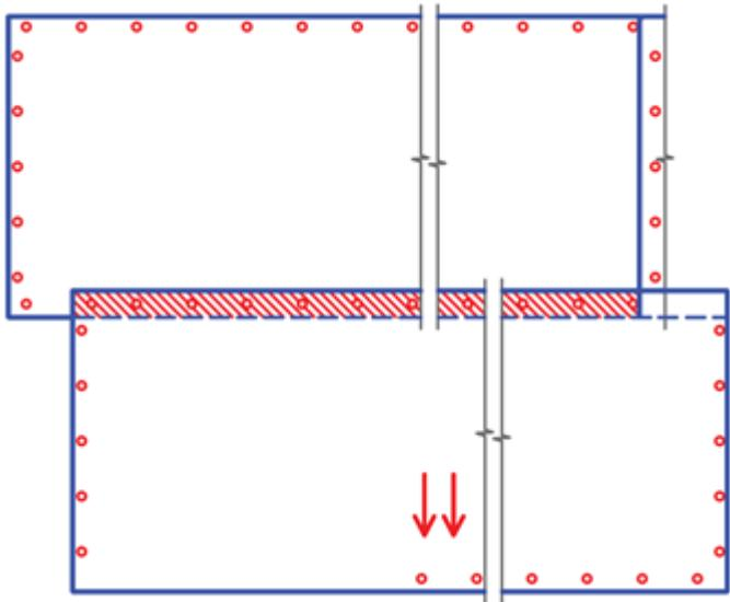
Дождитесь остывания шва. Натяните мембрану от сваренного края полотна и закрепляйте противоположный край полотна. Продолжайте укладку следующих полотен мембраны. После остановки ручной или автоматической сварки перед началом новой надо подорвать слегка шов, так как до **5 мм** шов может быть не проварен.
