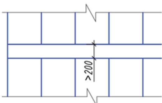
В случае невозможности осуществить монтаж полотен мембранны без смещения торцов уложите сборную полосу поперек основных полотен. Ширина сборной полосы должна составлять не более **1 м**.
