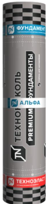
Для защиты от радона выпускается специализированный рулонный гидро-газоизоляционный битумно-полимерный материал - Техноэласт Альфа ЭФПП. Материал состоит из полиэфирной основы, сдублированной с металлической фольгой, на которую с двух сторон нанесено битумно-полимерное вяжущее. С обеих сторон материал защищён полимерной плёнкой.
