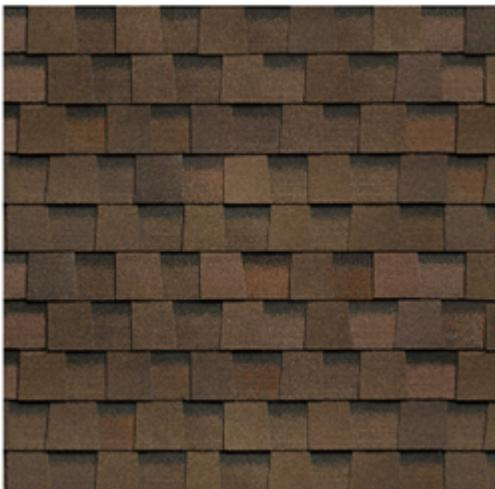
Многослойная черепица ТЕХНОНИКОЛЬ SHINGLAS, коллекция РАНЧО – это штучный битумосодержащий кровельный двухслойный материал. Изготавливается нарезанием листов из рулонного материала, получаемого путем пропитки и покрытия стекловолокнистой основы битумным вяжущим, с последующим нанесением различных видов защитных покрытий и склейкой двух листов разной формы. Гарантийный срок службы – 30 лет.
