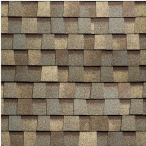
Многослойная черепица ТЕХНОНИКОЛЬ SHINGLAS, коллекция КАНТРИ – это штучный битумосодержащий кровельный двухслойный материал. Изготавливается нарезанием листов из рулонного материала, получаемого путем пропитки и покрытия стекловолокнистой основы битумным вяжущим, с последующим нанесением различных видов защитных покрытий и склейкой двух листов разной формы. Гарантийный срок службы – 50 лет.
