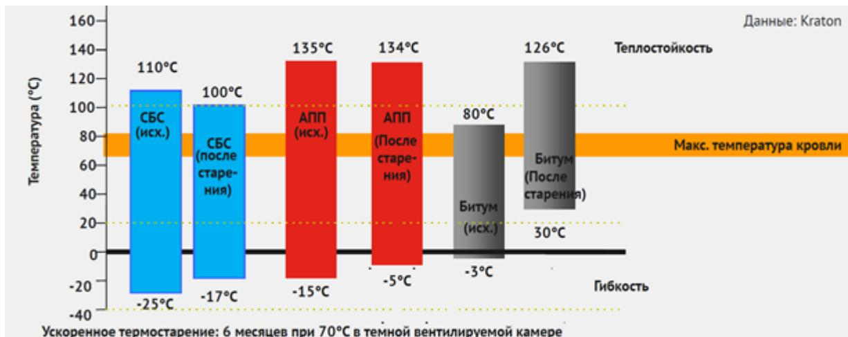
В соответствии с [ГОСТ 32806-2014](#) «Черепица битумная. Общие технические условия» требования к теплостойкости битумной черепицы не ниже +100°C, требования EN 544:2011 – не ниже +90°C.
