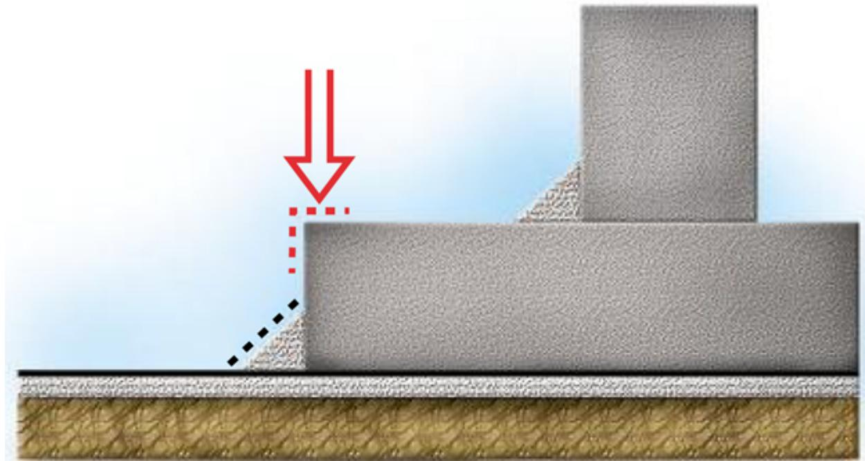
Наплавьте слой усиления в верхней части фундаментной плиты в месте смены направления с вертикали на горизонталь. Сначала на вертикальной поверхности.
