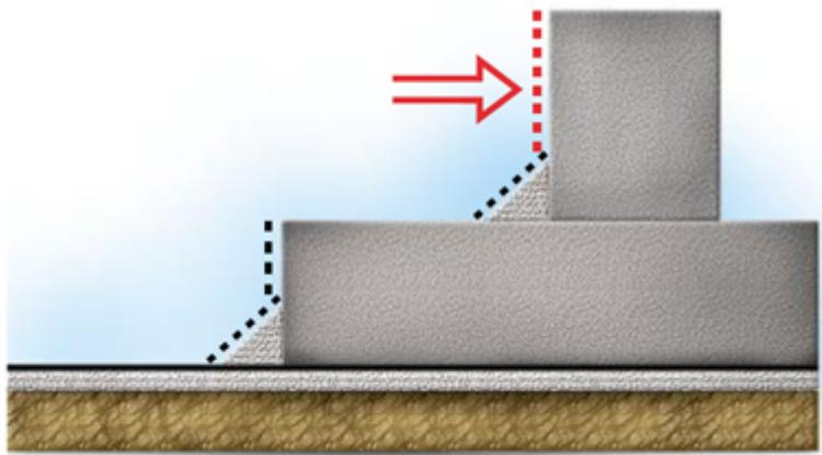
Выполните элемент усиления внешнего угла по ограждающей конструкции. Сначала разрежьте и примерьте заготовку по месту.
