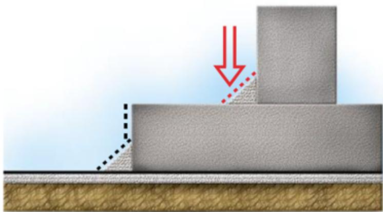
Выполните элемент усиления внешнего угла в месте перехода с горизонтальной поверхности фундаментной плиты на вертикальную поверхность ограждающей конструкции. Сначала разрежьте и примерьте заготовку по месту.
