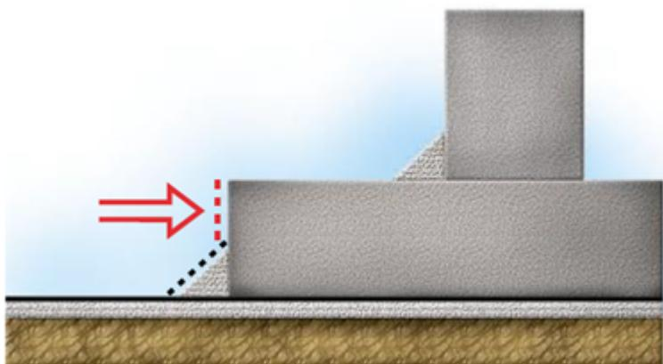
Выполните элемент усиления внешнего угла по фундаментной плите. Сначала разрежьте и примерьте заготовку по месту.
