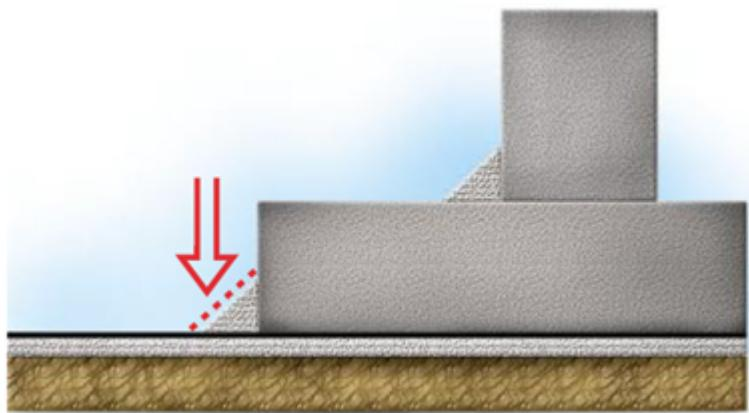
Выполните элемент усиления внешнего угла в месте перехода с бетонной подготовки на вертикальную поверхность фундаментной плиты. Сначала разрежьте и примерьте заготовку по месту.
