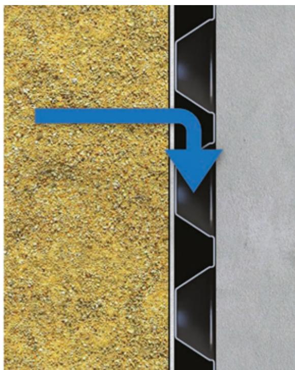
Применение профилированных мембран – это экономия средств по сравнению с традиционными трудоемкими способами организации защиты гидроизоляции (кирпичной кладкой или плоским шифером) и пристенного дренажа (песок, гравий).
