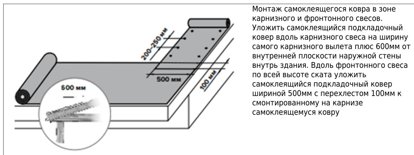
Монтаж самоклеящегося ковра в зоне карнизного и фронтонного свесов.
