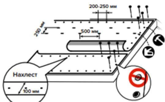
МОНТАЖ С ПОМОЩЬЮ КРОВЕЛЬНЫХ ЕРШЕНЫХ ГВОЗДЕЙ И МЕТАЛЛИЧЕСКИХ ОЦИНКОВАННЫХ СКОБ
