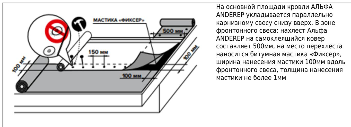
В зоне карнизного свеса: нахлест Альфа ANDEREP на самоклеящийся ковер в зоне карнизного свеса составляет 100мм, на место перехлеста наносится битумная мастика «Фиксер» на всю ширину перехлеста, толщина нанесения не более 1мм. Место перехлеста полимерного ковра с самоклеящимся фиксируется кровельными гвоздями с пластиковой шайбой в соответствии с разметкой. Диаметр шляпки гвоздя 5,5мм, диаметр пластиковой шайбы – 23мм. Расход гвоздей составляет 14-16 шт. на м<sup>2</sup> при угле наклона от 18°
