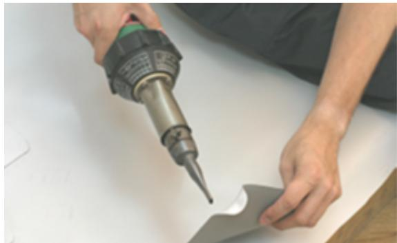
С помощью ручного фена прогрейте один из углов и растягивайте его до получения детали, как показано на фото.
