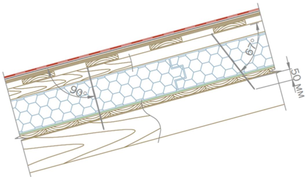
Крайние крепежи под 90° устанавливаются в карнизе и коньке на расстоянии 400 мм от соответственно карниза и конька крыши, шаг остальных крепежных элементов — 900 мм.
