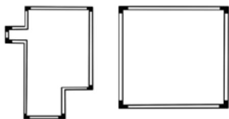
Все внешние углы здания являются зонами усиленного крепления (краевыми зонами), ширина зон – 1,5 м.
