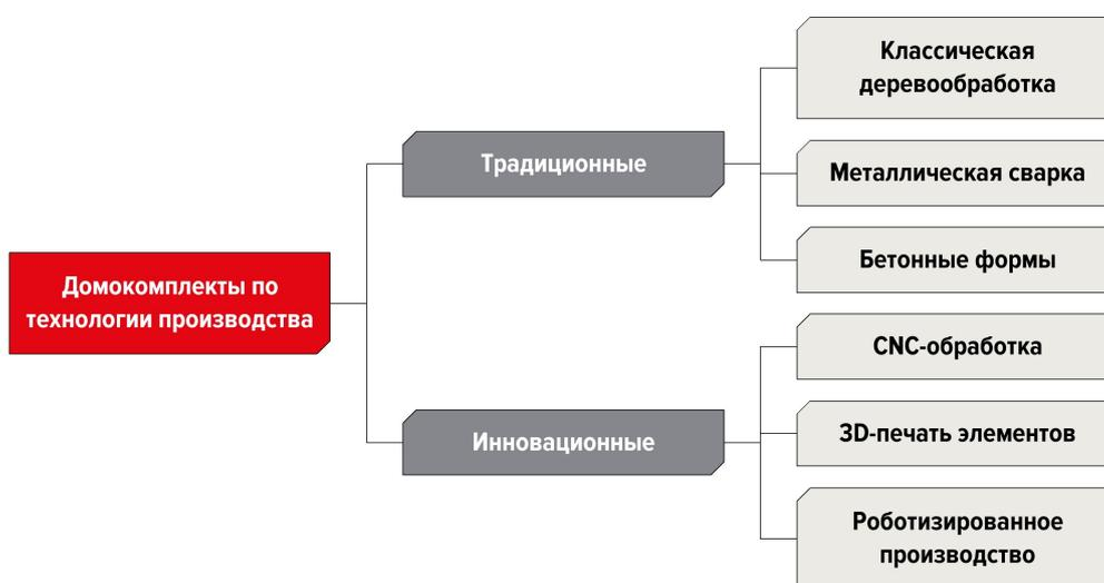
**Конвенциональная (традиционная) технологическая платформа** базируется на мануфактурном принципе обработки строительных элементов, где используется ручной труд и ограниченно применяются автоматизированные системы. Такой метод требует больше времени на производство и не всегда обеспечивает высокое качество изделий, так как многое зависит от навыков рабочих.
