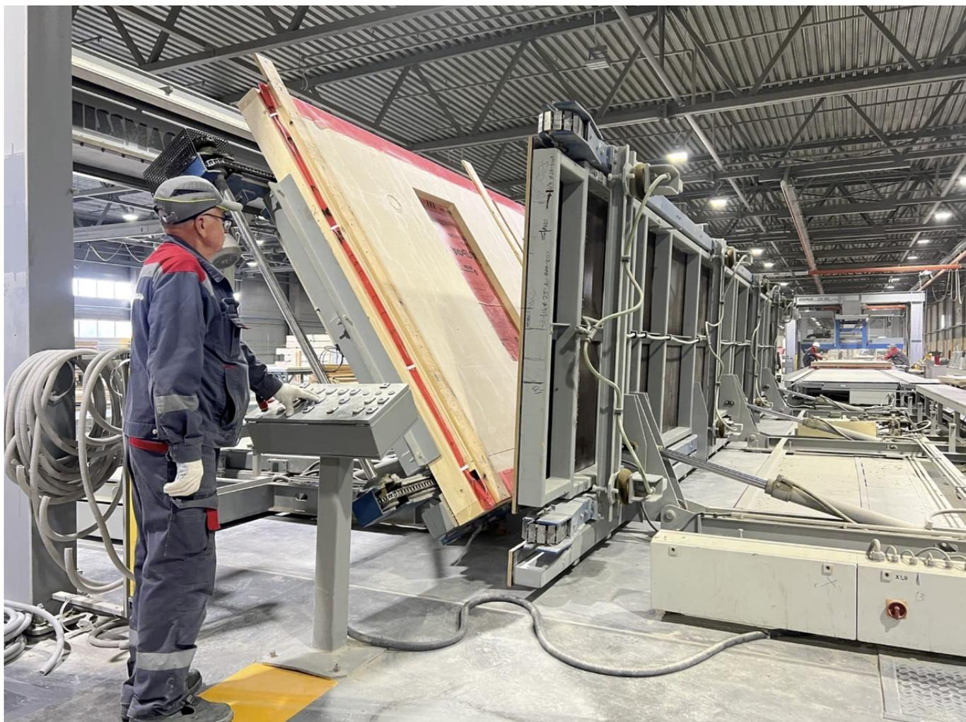
*Рис.2. Сборка стеновой панели на заводе МКД в городе Семенове*
