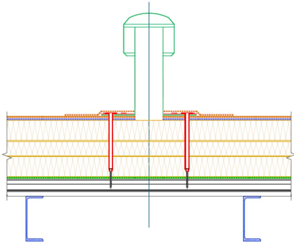
**Рекомендации по установке.** Кровельные аэраторы должны быть равномерно распределены по поверхности крыши. Расстояние между ними рекомендуем соблюдать не более 10 м.
