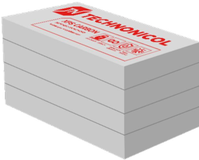
Блоки изготавливаются с помощью технологии термосклейки (THERMOBONDING): несколько плит XPS склеиваются между собой, таким образом получают изделие большей толщины. Чтобы надежно склеить плиты, их поверхности нагревают до пластичного состояния, а затем соединяют друг с другом.
