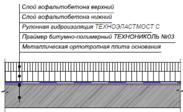
**Ортотропная плита – плита, состоящая из пересекающихся продольных рёбер и поперечных балок, приваренных к листу настила. Жёсткость такой плиты различна в**
