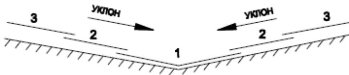
**Допускается поперечная раскатка рулонов в пределах тротуаров с расположением нахлестки рулонов материала в поперечном направлении с учетом продольного уклона так, чтобы верхний рулон был наклеен с повышенного места**
