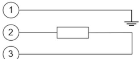
Длина кабеля ПВС 3х0.75 - 1 метр. Греющий кабель находится внутри воронки и соединен с кабелем ПВС при помощи муфты (см. рис.).
