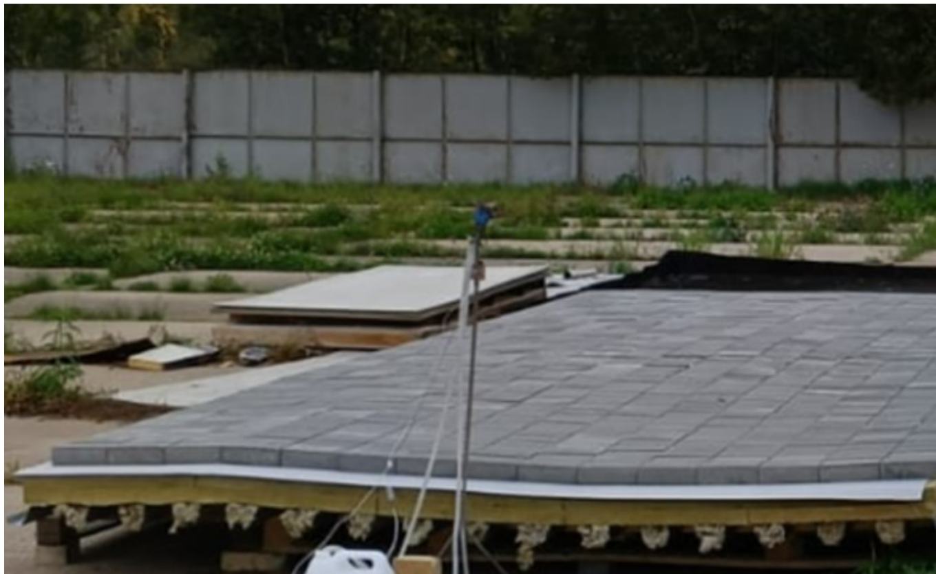
Фото 1. Стандартное решение противопожарного пояса с тротуарной плиткой
