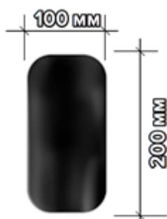
Наплавьте заплатку на угловое сопряжение с переходным бортиком.
