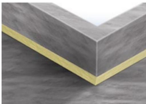
Установите и наплавьте полосы слоя усиления из материала Техноэласт ЭПП на наклонный бортик со стороны парапета, где материал будет подходить боковой частью.
