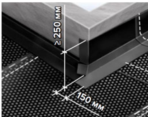
Материал должен перекрывать другую сторону парапета на 100 мм, заходить на горизонтальную плоскость кровли на 150 мм и должен быть заведен на высоту не менее чем на 300 мм на парапет. Наплавьте дополнительный нижний слой с другой стороны внешнего угла.
