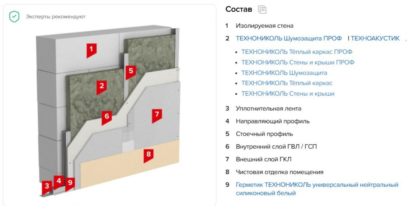
Основные этапы работ по сборке звукоизоляционного каркаса выглядят так:
