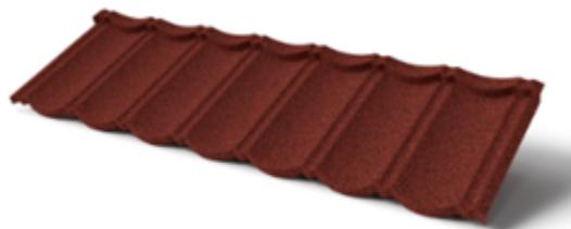
Композитная черепица ТЕХНОНИКОЛЬ LUXARD Roman – это форма панели композитной черепицы LUXARD. Многослойный кровельный материал, выполненный на основе стального листа толщиной 0,45 мм, покрытого с двух сторон слоями алюмоцинка, защитного покрытия и нанесенным на лицевую сторону покрытием, состоящим из акрилового грунта, гранул природного камня и УФ-стойкого защитного акрилового лака. Гарантийный срок службы – 50 лет.
