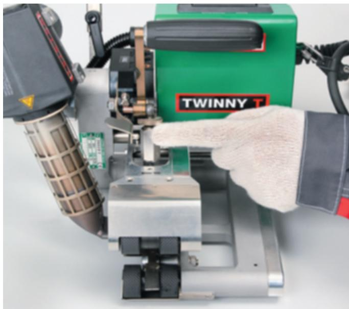
После такой регулировки при зажиме двух слоев мембранны между роликами при выполнении сварки на материал будет оказываться необходимое давление 600 Н.
