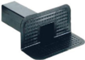
Воронка ULTRA парапетная 110 — воронка является парапетным переливом, которая устанавливается в случаях аварийного сброса воды при засорении основной воронки внутреннего водостока.
