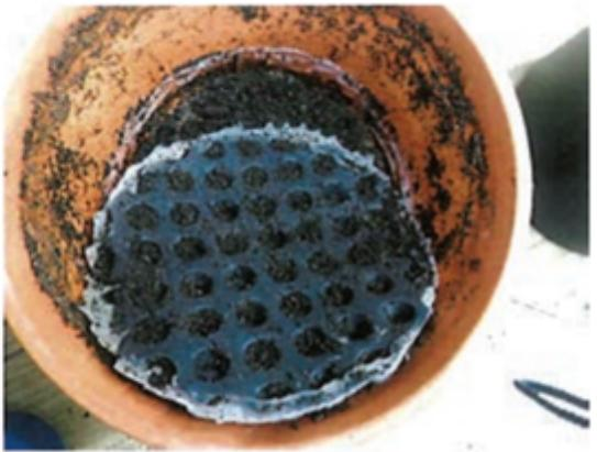
Мембранны PLANTER стойки к воздействию химических реагентов (кислоты, щелочи, соли), содержащихся в защитных и растительных слоях эксплуатируемых кровель.
