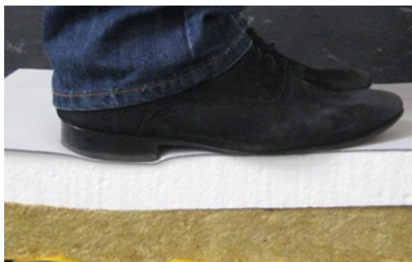
Кроме того, низкая прочность является причиной порчи материала при монтаже – материал, имеющий низкую прочность может ломаться или крошиться при механических воздействиях.
