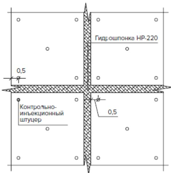
Очистите фланец штуцера. Очистите поверхность мембраны в месте установки штуцера. Ручным аппаратом точечно приварите фланец штуцера к поверхности мембраны.
