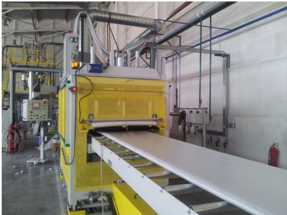
С 2011 года **XPS ТЕХНОНИКОЛЬ** производится по уникальной технологии с применением частиц графита для улучшения физико-механических характеристик: увеличение прочности, снижение теплопроводности и стабильность данного показателя на протяжении всего срока службы.
