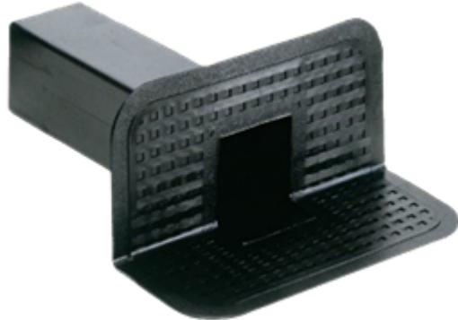
Воронка ULTRA парapетная 110 — воронка является парapетным переливом, которая устанавливается в случаях аварийного сброса воды при засорении основной воронки внутреннего водостока.
