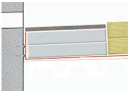
4. Вырежьте из материала Техноэласт ЭПП слой усиления и наплавьте в область местного понижения водоприемной воронки. Слой усиления должен быть на 100 мм больше фланца парапетной воронки с каждой стороны.
