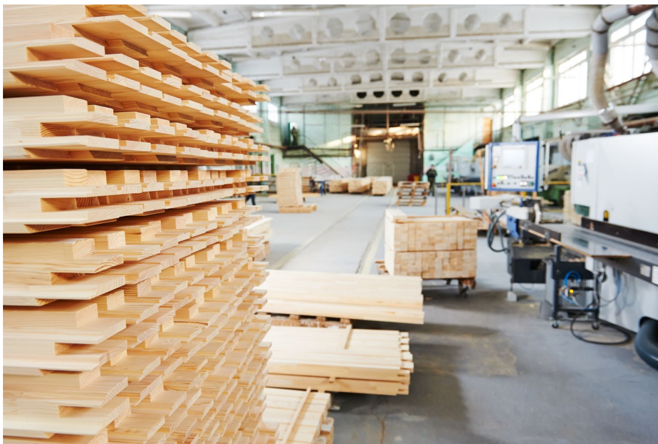
Укладка доски в штабели с возможностью просушки
