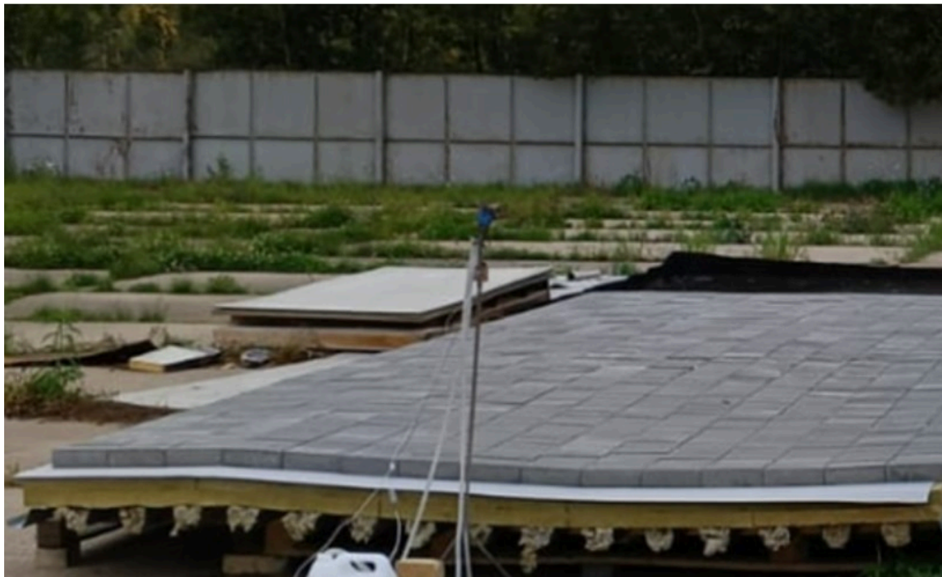
Фото 1. Стандартное решение противопожарного пояса с тротуарной плиткой
