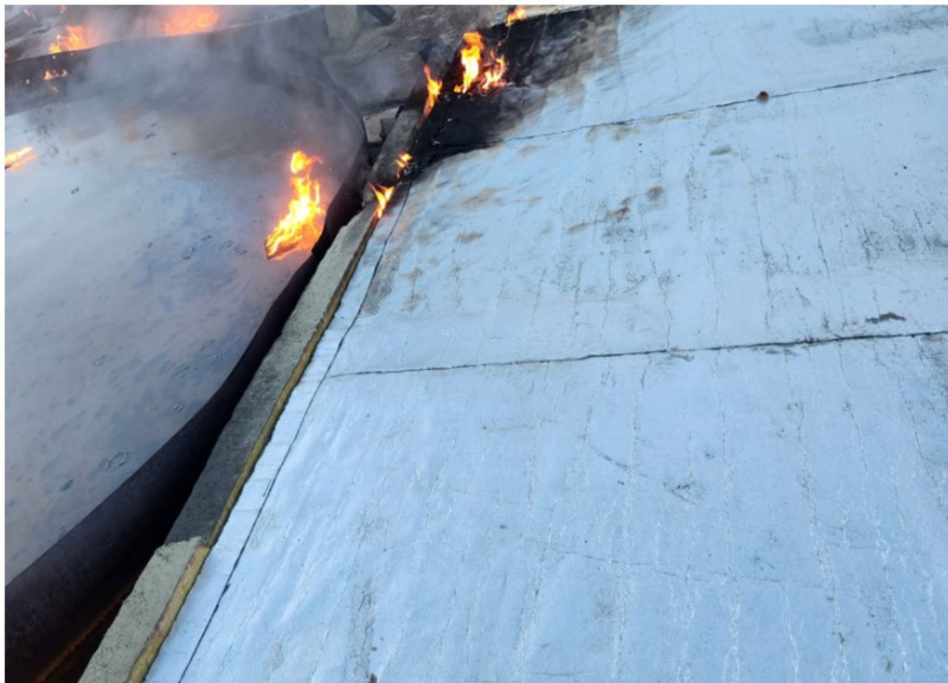
Фото 4. Результаты испытания противопожарного пояса с материалом Техноэласт ТФП Противопожарный
