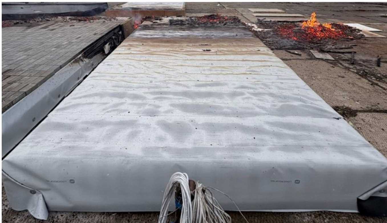
Фото 5. Результаты испытания противопожарного пояса с материалом рулонный противопожарный защитный материал LOGICROOF NG
