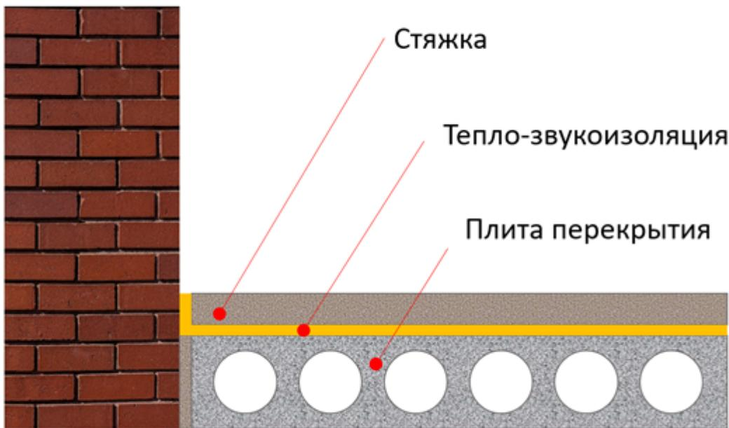
«Плавающие» стяжки на изолирующем слое с основанием не связываются. Это самостоятельная строительная конструкция. Такие стяжки можно встретить чаще всего при новом строительстве. Конструкция стяжки в этом случае менее подвержена растрескиванию при эксплуатации.
