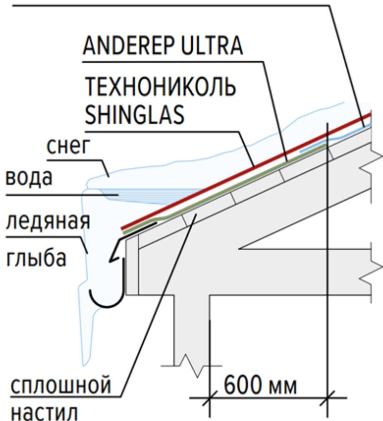
**ВАЖНО!** Данное решение предотвращает появление нежелательных протечек в карнизной зоне здания или сооружения вследствие нарушения температурно-влажностного режима подкровельного пространства либо резких изменений температуры окружающей среды.
