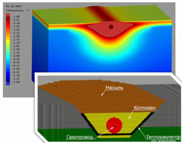
Стоит отметить сложность технологии возведения трубопроводов с теплоизоляцией плитами по контуру котлована. При производстве монтажных работ возникает множество трудностей с размещением и закреплением плит и с обратной засыпкой грунта, что кратно снижает качество, и увеличивает сроки производимых работ.
