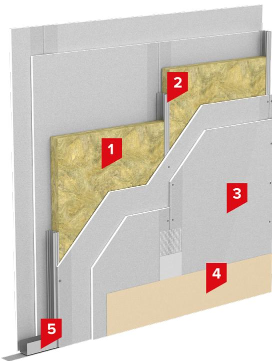
Звукоизолирующая способность перегородок характеризуется индексом звукоизоляции воздушного шума  $R_w$ , исчисляемого в децибелах (дБ). Чем выше его значение, тем лучше звукоизоляция помещения. Применение различных комбинаций толщин утеплителя и количества слоев обшивки позволяет снизить уровень воздушного шума до 59 дБ (см. таблицу 1).
