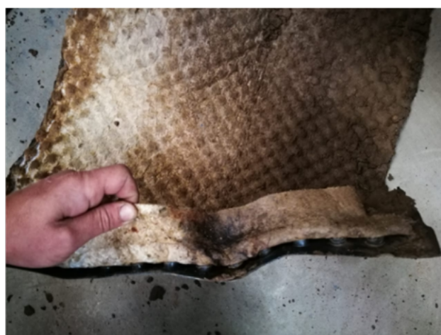
Рис. 8. Заиливание геотекстиля дренажной мембраны.
