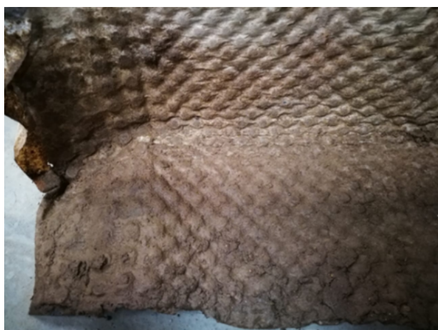
Рис. 8. Заиливание геотекстиля дренажной мембраны.
