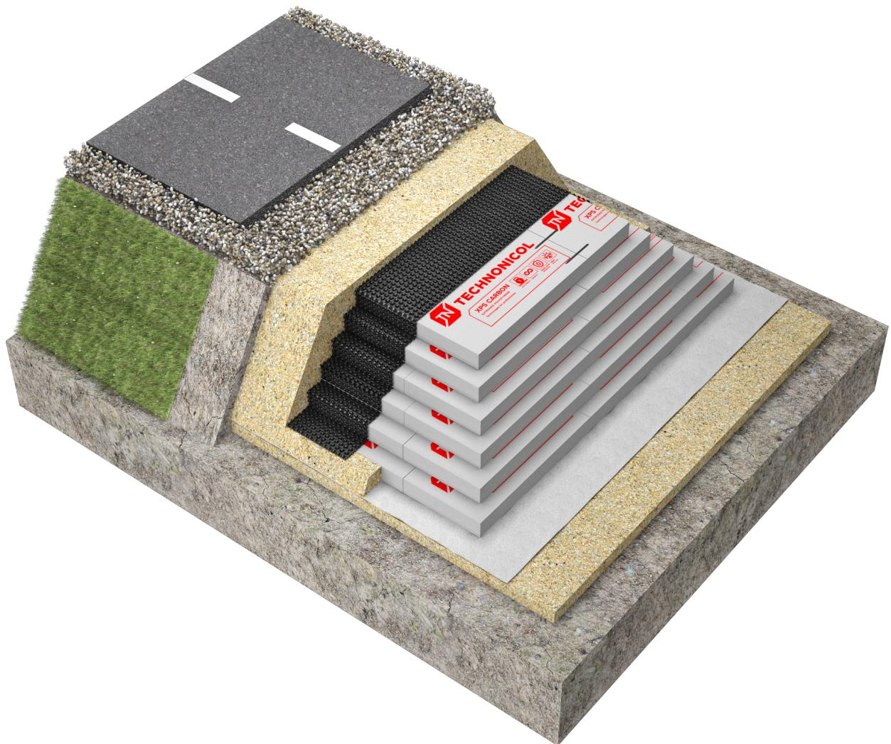
Для значительного сокращения трудозатрат при возведении облегченных насыпей компанией ТЕХНОНИКОЛЬ выпускается Экструзионный пенополистирол ТЕХНОНИКОЛЬ CARBON BLOCK в виде блоков больших размеров\*:
