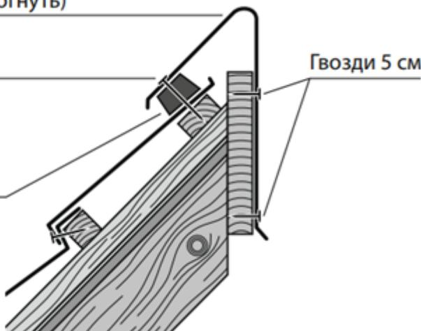
Полукруглые коньковые элементы уложите с нахлестом 2 см и зафиксируйте сверху по краям гальванизированными гвоздями либо гальванизированными саморезами к коньковому брусу. Если кровля односкатная, конек выполните согласно рисунку выше. Плоский лист согните и обрежьте согласно уклону кровли и толщине стропил. Поверх плоского листа в декоративных целях можно закрепить полукруглые коньки.
