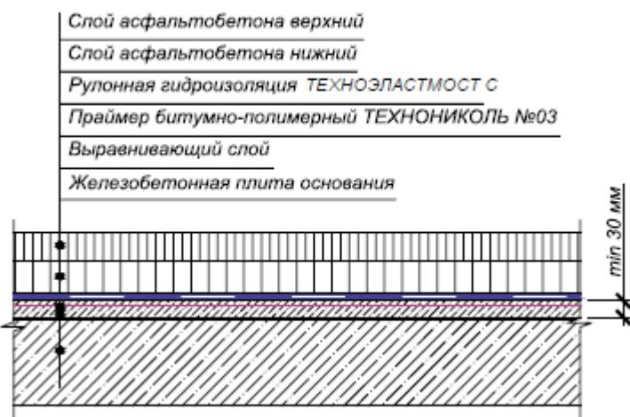
Выравнивающий слой может быть выполнен переменной толщины для придания поверхности
