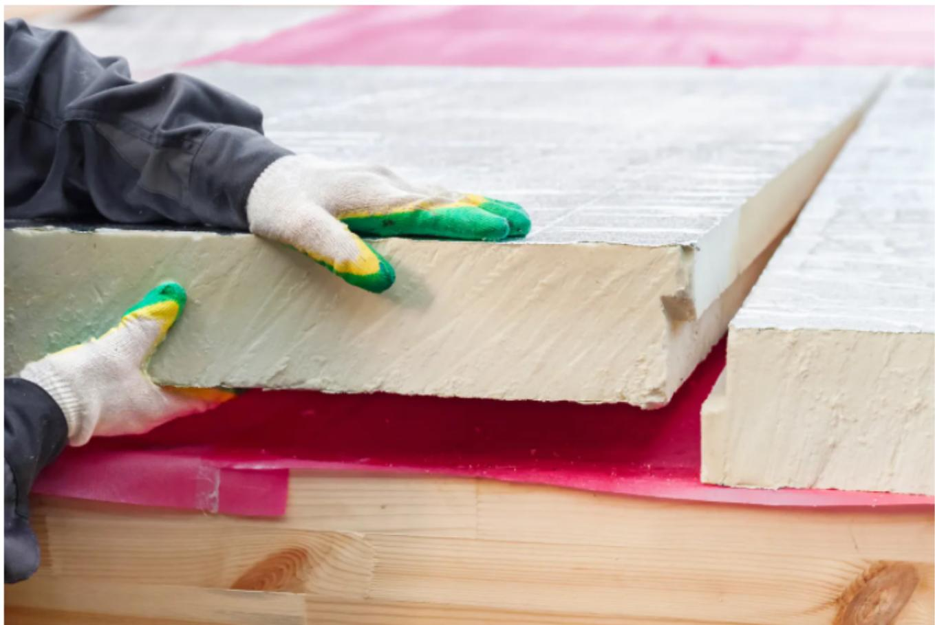
Ещё одно существенное отличие – использование других вспенивающих агентов. До 2011 года в производстве PIR применяли фреон-11, а после его запрета в рамках климатических соглашений стали использовать пентан – низкотеплопроводный газ, относящийся к группе предельных углеводородов класса алканов.
