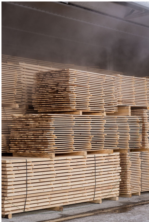
Пиломатериал в сушильной камере
