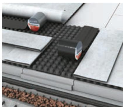
Скрепите геотекстиль для формирования целостности фильтрующего слоя. Используйте двух- или одностороннюю клейкую ленту для соединения геотекстиля. Если клейкая лента односторонняя, ее ширина должна быть не менее 50 мм.
