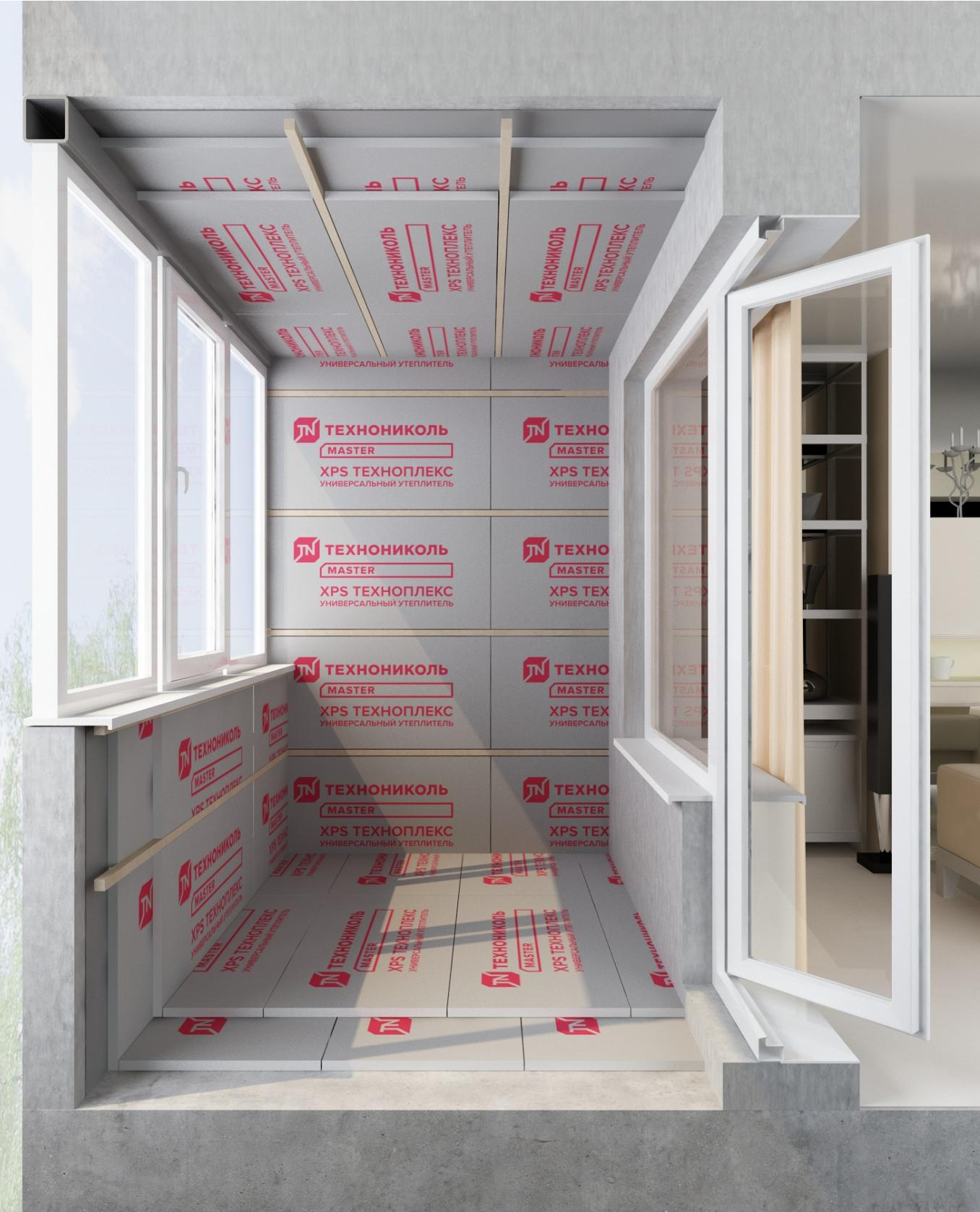
5. Необходимо смонтировать герметичный пароизоляционный слой из Пленки ТЕХНОНИКОЛЬ АЛЬФА БАРЬЕР 4.0. Швы пароизоляционной плёнки должны быть проклеены с помощью специальной двусторонней клейкой ленты.
