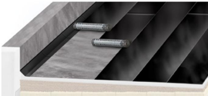
Торцевую часть рулона можно завести на наклонный бортик без устройства слоя усиления. Это возможно только при подведении рулона к вертикальной конструкции торцевой частью: на вертикальную поверхность торцевая часть рулона должна заходить на 25 мм выше от наклонного бортика.
