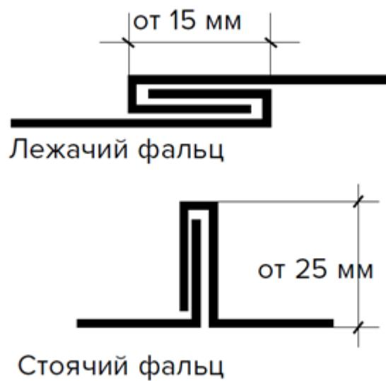
Для защиты парапетов, применяются разные варианты парапетных фартуков. Профиль крепежного элемента (кровельного костыля) зависит от формы самого оцинкованного фартука:
