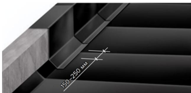
Укладку дополнительного нижнего слоя Техноэласт ЭПП на парапет нужно начинать с пониженных участков кровли ендлов для предотвращения противошовки. Вода должна стекать
