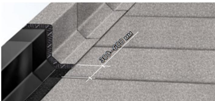
Завершите наплавление, приплавив нижнюю часть рулона с заведением на горизонтальный участок и на фасадную часть парапета на 50 мм.
