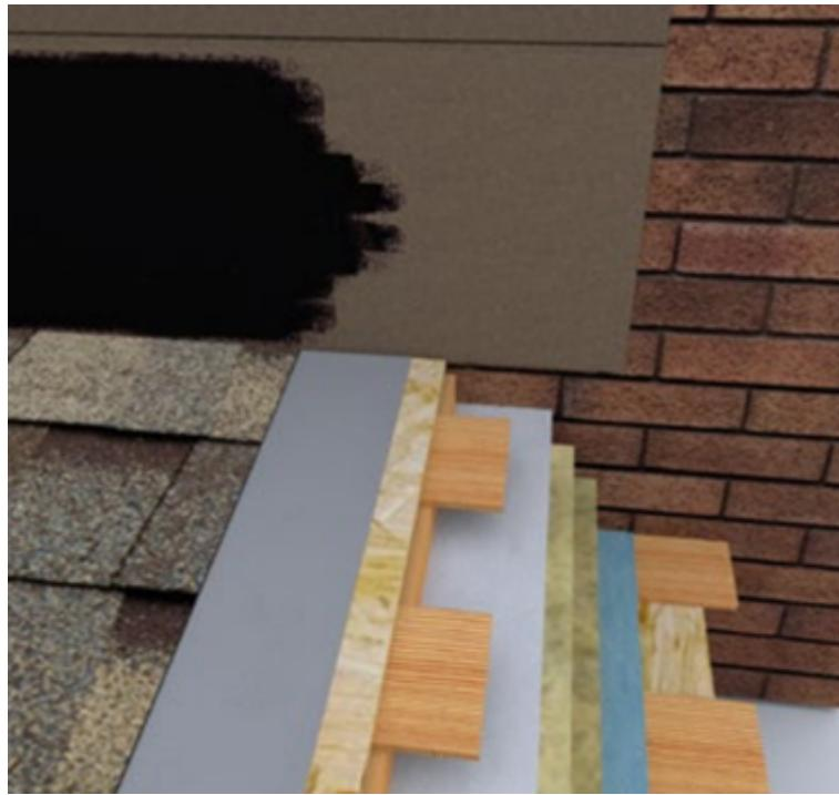
4. Нанести битумную мастику ТЕХНОНИКОЛЬ ФИКСЕР на всю тыльную поверхность выкройки ендовного ковра ТЕХНОНИКОЛЬ. Полоса ендового ковра должна быть шириной не менее 500 мм.
