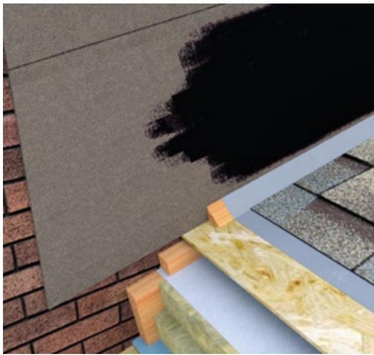
2. Ендовый ковер приклейте на битумную мастику по аналогии с устройством прямого примыкания: на праймированную поверхность полоса заводится не менее чем на 300 мм, на рядовую черепицу – 200 мм.
