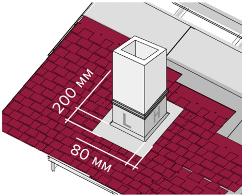
4. Полученные выкройки сгибаются или надрезаются в определенных местах согласно схеме. Схема выкройки из ендового ковра.
